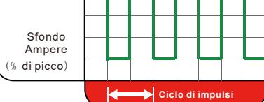
Oltre i 40 PPS, il TIG Pulsato diventa più udibile che visibile causando un aumento della pozzanghera agitazione per una migliore microstruttura come saldata.
