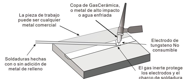
Tinta de aplicación de soldadura TIG
