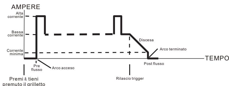
Modalità 4T Latch questa modalità di saldatura viene utilizzata principalmente per lunghi cicli di saldatura per ridurre stanchezza dell'operatore. In questa modalità l'operatore può premere e rilasciare il pulsante torcia e l'uscita rimarrà attiva. Per disattivare la fonte di alimentazione, l'interruttore a grilletto deve essere nuovamente premuto e rilasciato, eliminando così la necessità per l'operatore di tenere premuto il grilletto della torcia.
