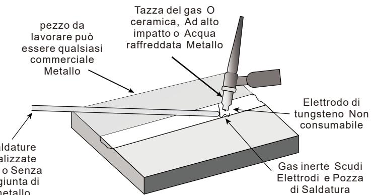
Colpo dell'applicazione di saldatura TIG
