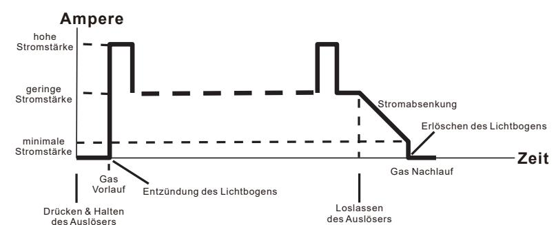
Dieser Schweißmodus wird vorwiegend für lang andauernde Schweißvorgänge verwendet, um die Ermüdung des Schweißers zu reduzieren. In diesem Modus kann der Schweißer den Brennerschalter drücken und wieder freigeben, die Schweißstromabgabe wird dabei nicht unterbrochen. Zum Deaktivieren der Schweißstromquelle muss der Brennerschalter erneut gedrückt und freigegeben werden. Auf diese Weise muss der Schweißer den Brennerschalter nicht ständig gedrückt halten.
