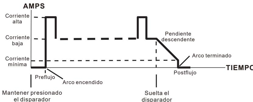
Modo de cierre de 4T: este modo de soldadura se utiliza principalmente para largos recorridos de soldadura para reducir la fatiga del operador. En este modo, el operador puede presionar y soltar el disparador de la antorcha y la salida permanecerá activa. Para desactivar la fuente de alimentación, el interruptor de disparador debe ser presionado y soltado nuevamente, eliminando así la necesidad de que el operador sostenga el disparador de la antorcha..
