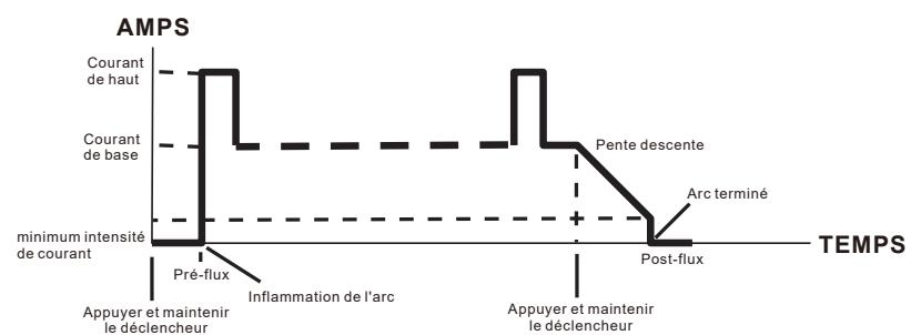
Mode de verrouillage 4T, ce mode de soudage est principalement utilisé pour les longs cycles de soudage afin de réduire la fatigue de l'opérateur. Dans ce mode, l'opérateur peut appuyer et relâcher le déclencheur de la torche et la sortie restera active. Pour désactiver la source d'alimentation, le déclencheur de la torche doit à nouveau être enfoncé et relâché, ce qui évite à l'opérateur de devoir maintenir le déclencheur de la torche.
